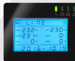
Painel frontal da UPS Exibe informações vitais de funcionamento da UPS e permite o comando das principais operações.
