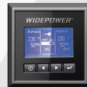
Painel frontal da UPS Exibe informações vitais de funcionamento da UPS e permite o comando das principais operações.
