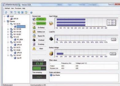
**Software de comunicação e gestão "user-friendly", apresenta informação em tempo real de forma gráfica, de dados importantes tais como; tensão de entrada, tensão de saída, carga da UPS, carga das baterias, etc. Permite ainda a visualização de logs, eventos, parâmetros de funcionamento de forma a auxiliar o diagnóstico de alarmes ou condições potenciais de falhas.**
