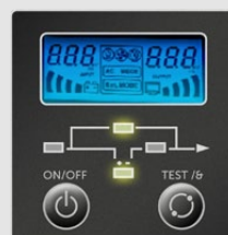
Painel frontal da UPS Exibe informações vitais de funcionamento da UPS e permite o comando das principais operações.
